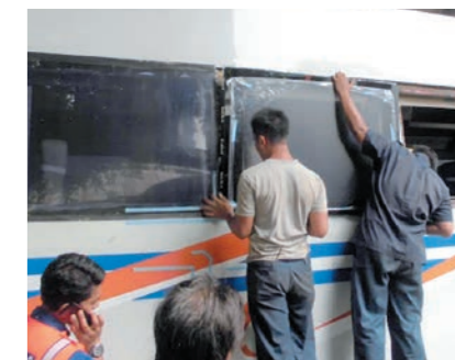
JR北海道の依頼で開発に至った「ポリカーボネート板とガラスの複合窓ユニット」は、世界の鉄道車両で使われている。インドネシアの鉄道での取り付け作業
